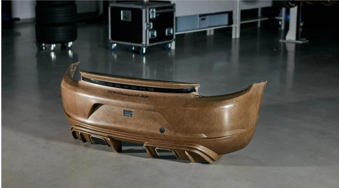
车门部分以密度较小的轻木作为核心,采用与碳纤维部件生产方式相同的夹层结构和树枝传递模塑工艺 (RTM)。尾翼则是各层先用环氧树脂浸渍,然后在高压釜中进行烘烤。此次新增的部件由天然纤维增强塑料采用真空注塑制作而成,并凭借 **Bcomp** 公司独家的 **powerRibs™** 技术满足刚度要求。
