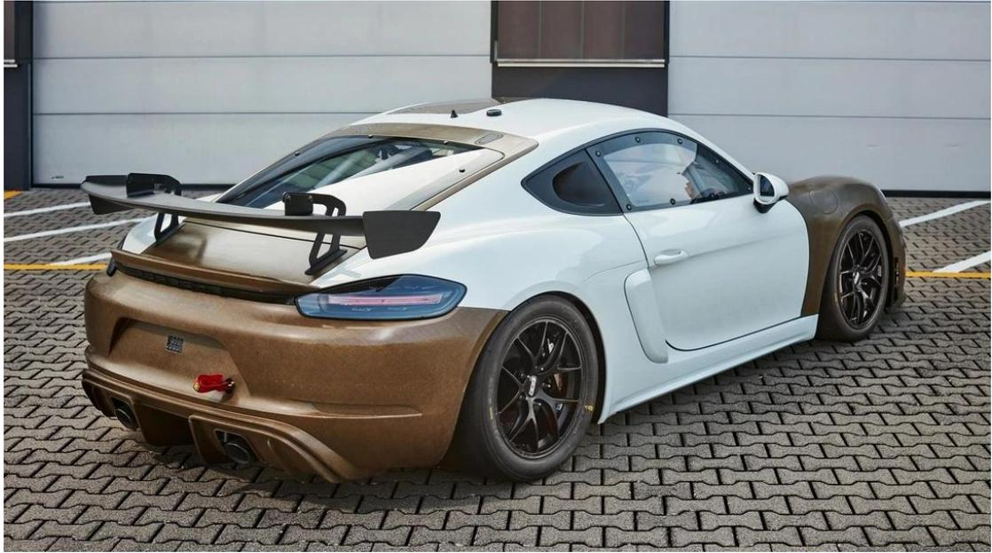
尾翼的各层先用环氧树脂浸渍，然后在高压釜中进行烘烤。
