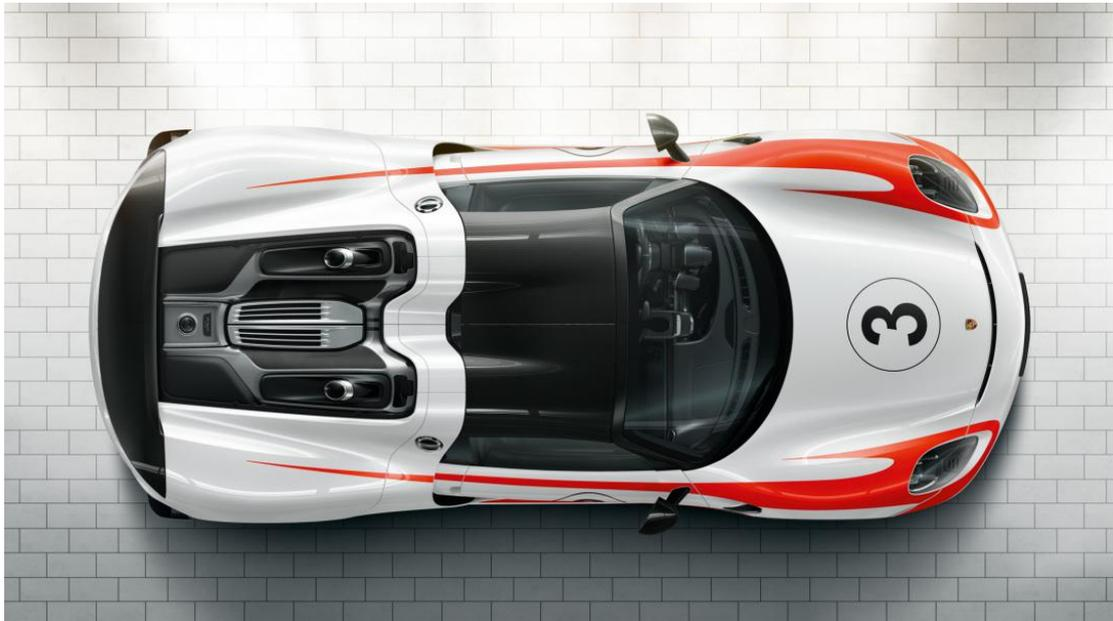
V8 发动机是对 RS Spyder 赛车上那台缸内直喷发动机的更进一步开发，如今它能在 10,300 rpm 输出最大功率 563 PS，安装在前轴的两个电机各贡献 75 kW，合计 150 kW，整车系统总功率达到 767 PS。飞轮蓄能器则可储存在制动时回收的额外能量。
