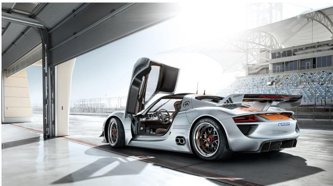
从外部来看，车辆背部的风扇和两个冲压进气管以及与 **RS Spyder** 相近规格的尾翼是 **918 RSR** 的主要特征，新设计的“液态金属铬蓝”色使得车辆的轮廓和线条更为突出，轻量化方面主要运用了碳纤维增强塑料单体壳车身这一源于赛车运动的技术。
