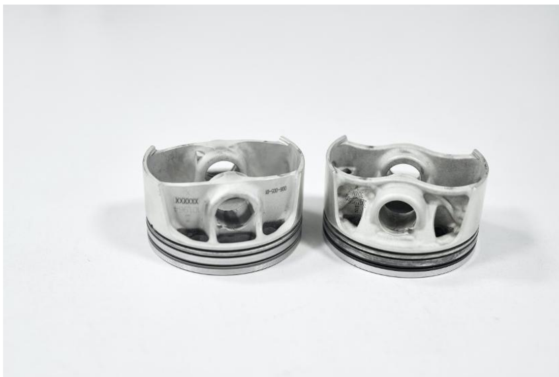
由 3D 打印机生产的 911 GT2 RS 活塞（右）与量产锻造活塞（左）对比
