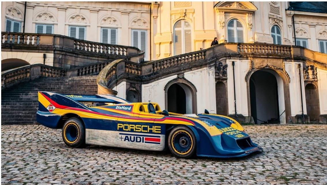
1973 年，针对 CarAm 系列赛开发出来的 917/30，1200 马力、风冷、12 缸，百公里加速仅需 2.1 秒，驾驶位左右各带 200 升汽油，没有任何计算机辅助技术作为协助在赛道上行驶，开起来特别生猛，特别有男子汉气概。
