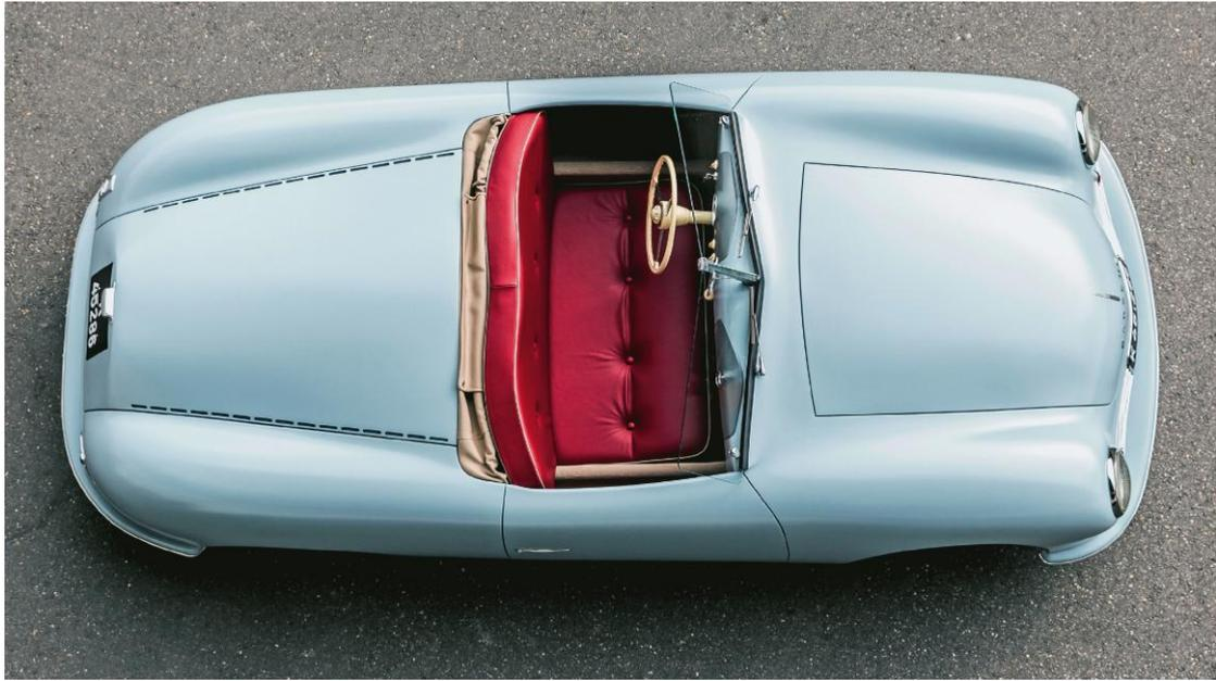
原版的保时捷 356 Roadster 尾部逐渐呈现锥形，头部的“鼻子”更加明显，尾部原本只有一块向后掀起的后盖由乘客厢伸展到保险杠，后来换成两段，一块横向盖板覆盖发动机，后备箱盖也就变短了。最终，在原版木制模具的帮助下，使用 70 年前铝制车身相似的方式，保时捷 356 “No.1” Roadster 车身的复刻版终于成型。
