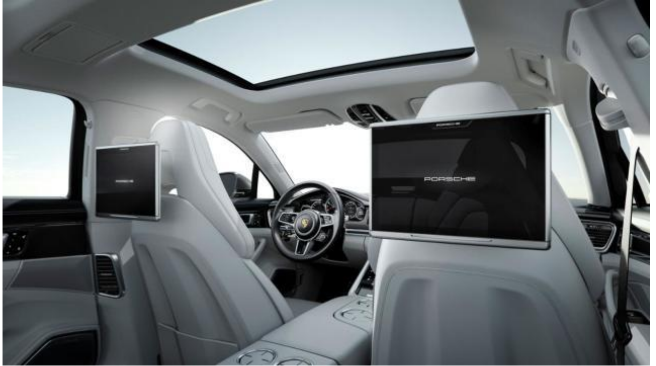
两块 10.1 英寸屏幕将后排变成“数字化工作区”，还可以取出车外当平板电脑使用
