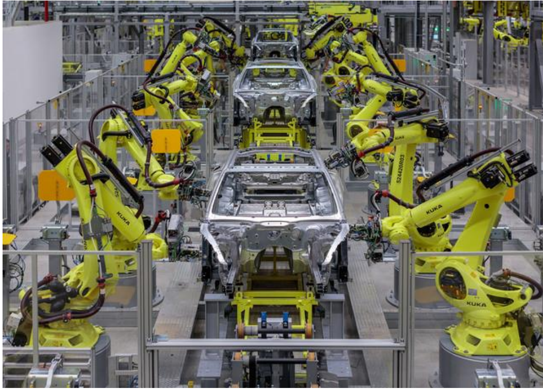
KUKA 机器人正在兢兢业业地进行焊接工作，确保所有 baby 都是 Porsche 品质
