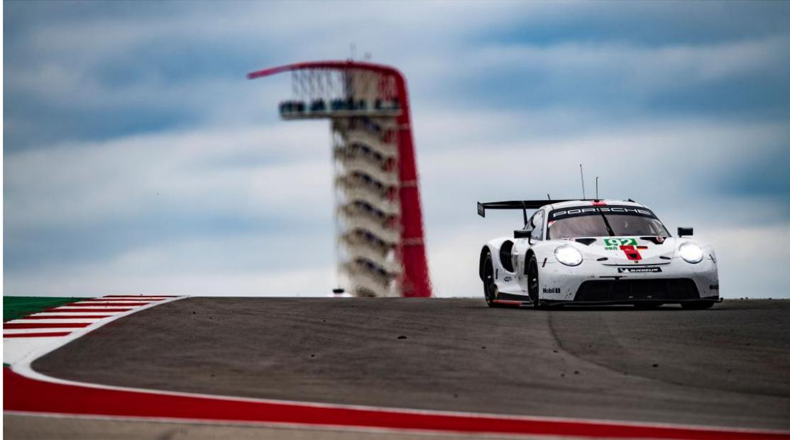
与它极其成功的前辈车型相比, 这台为世界耐力锦标赛 GT-Pro 组别打造的赛车在驾驶性能、效率、人体工程学和适用性等方面都得到了改进。大约有 95% 的部件是全新的。911 RSR 的动力源于一台 4.2 升 6 缸的自然吸气水平对置发动机。
